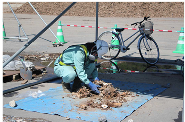
廃棄物を一定のルールに従って混ぜ返し、放射能測定用のサンプルを作成しているところ
