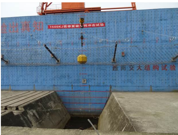
写真7 落下実験(4tの重錘: 1,500kJ)
