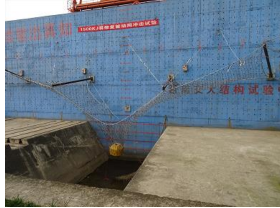
1500 キロジュールの重錘を捕捉
