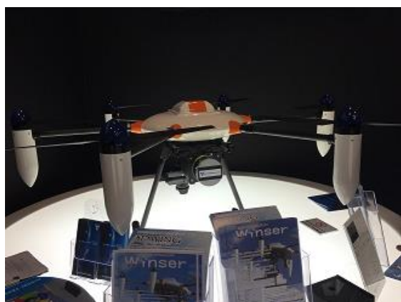
カメラと3Dレーザー扫描仪を搭載した機体
