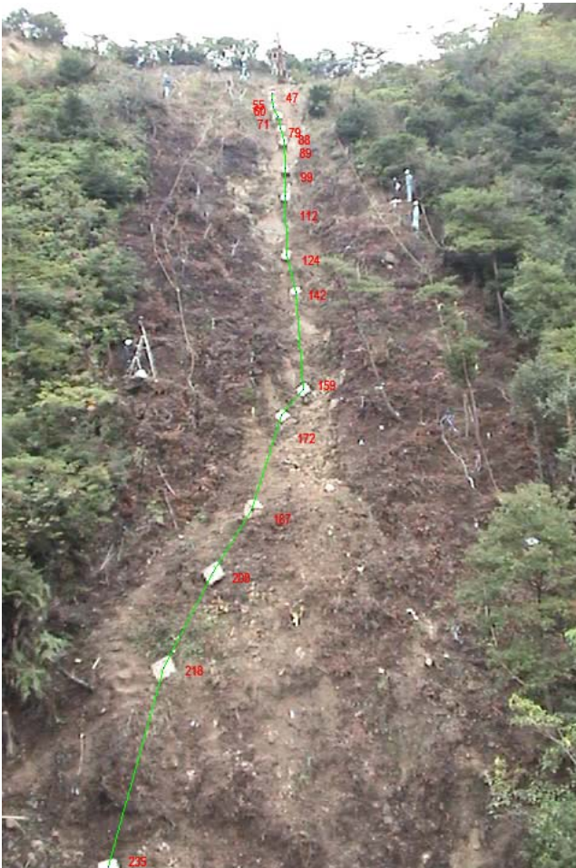
写真3 立方体の落下状況(立木伐採後)
