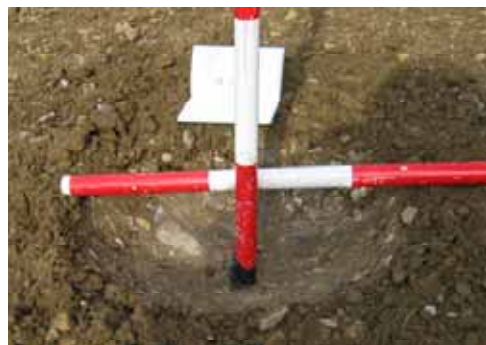
写真 - 7 衝突後の表土の窪み(表土20cm, 落下高10m)
