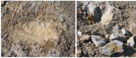
[左上] 岩盤の変形による窪み(落下高4m) 窪みの直径14~15cm, 深さ1cm [右上] 岩盤の節理面に沿った くさび状破壊(落下高6m) [左下] 衝突時の接触面には 岩盤の破碎粒子が付着
