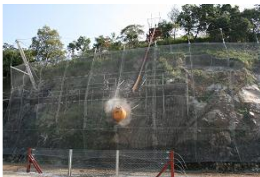
図-9 2.1tの重錘を速度19.5m/sで衝突させた様子。落石エネルギーは400kJ(第3回目公開実験2008年12月8日) 5)
