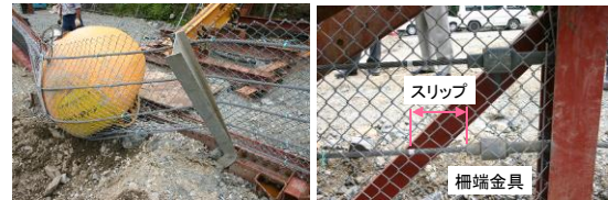
図-12 落石防護柵の実験 7)
