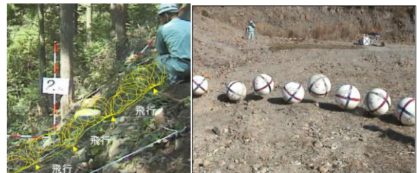
図-2 落石の運動 4)
