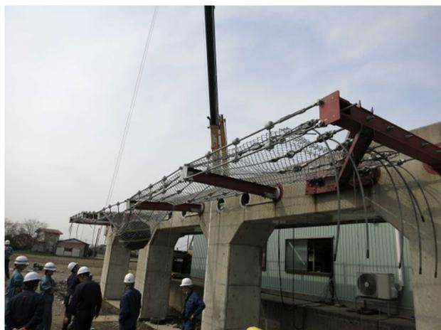
重錘は中央スパンに落下させた。日を改めて、端部のスパンにも落下させる実験を予定しておられる。
