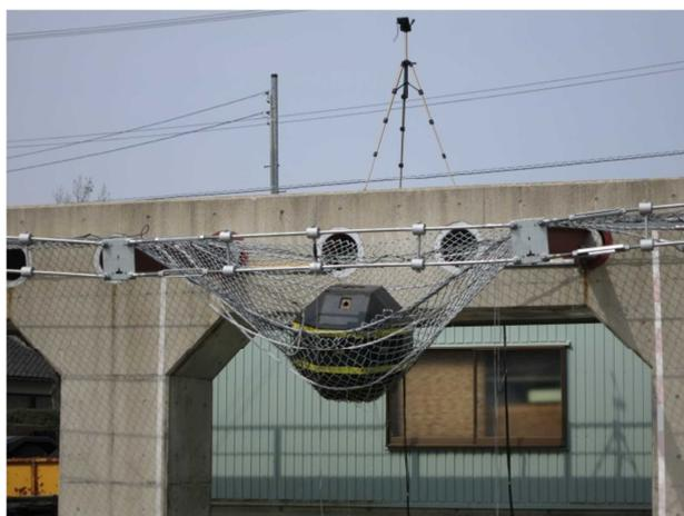
衝突速度  $v=16\text{m/s}$ ，運動エネルギー  $E=100\text{kJ}$  で衝突した重錘を見事に受け止めた。
