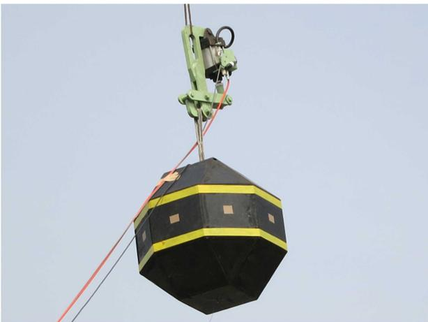
実験に使用された重さ 0.78 トンの重錘。トラックレーンで吊り上げて自由落下させる。そのため離脱装置が見られる。
