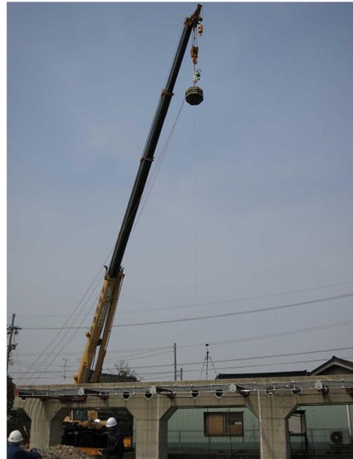
実験は、防護柵実験専用で作られたコンクリート構造の基礎に、防護柵を水平に設置し、クレーンで13.07mの高さまで吊り上げ、自由落下させる。
