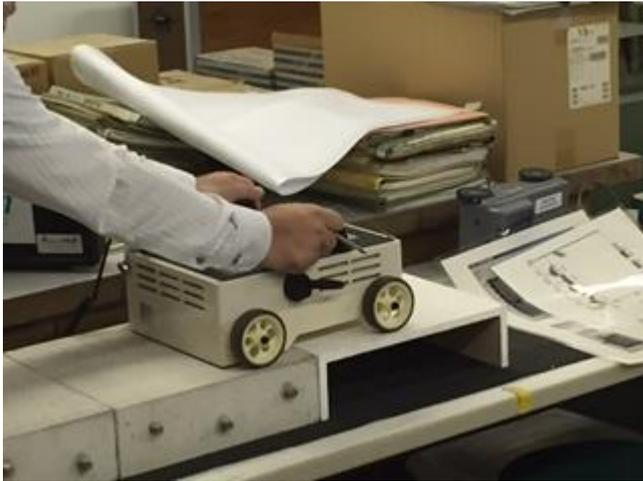
電磁波レーダ法による鉄筋探査
