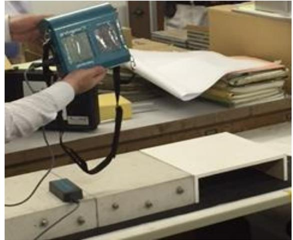
電磁誘導法による鉄筋探査
