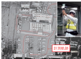
図-3 計測した3D点群と計測軌跡
