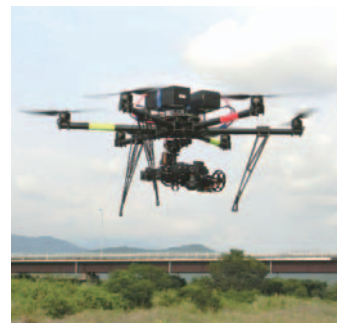
UAV(ドローン)による 三次元地形測量
