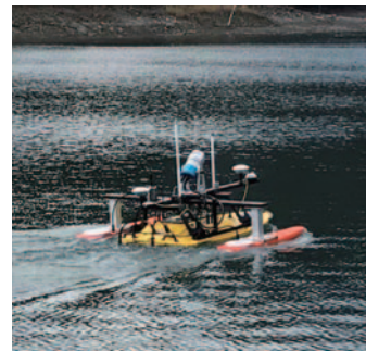
マルチビームによる 水面下の三次元地形測量
