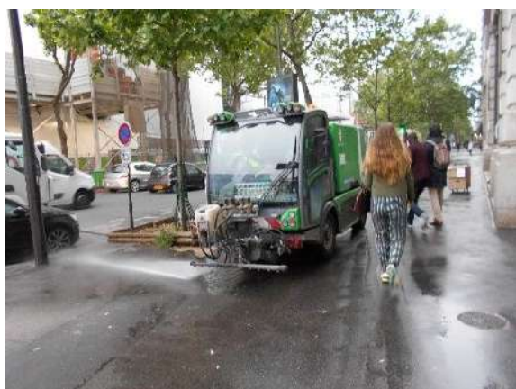
写真6 ジェット水流による清掃
