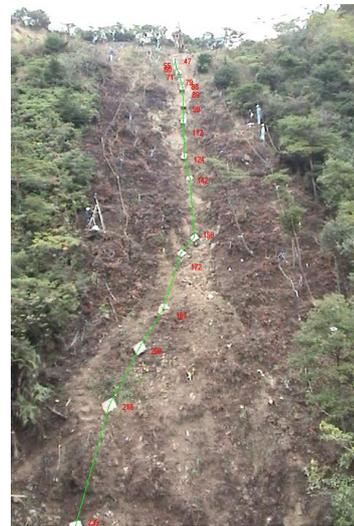
写真 4 斜面を落下するコンクリート立方体
