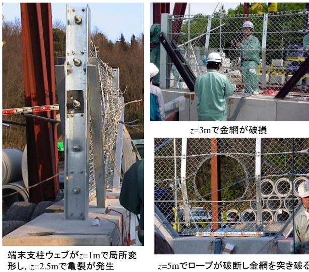
写真-6 端末支柱と金網の破損状態。
