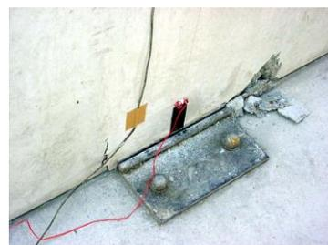
写真-1 供試体の前面に設置したストッパー
