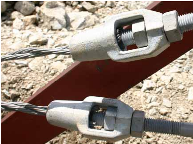
写真 12 上のロープはストランドが1本抜けている 写真 13 ャックからストランドの抜け出し
