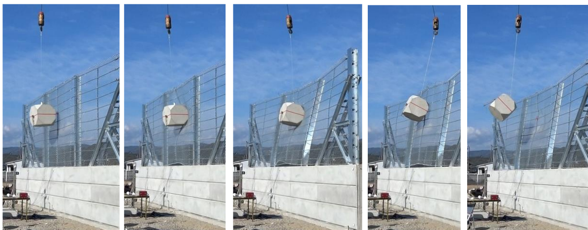
防護柵へ重錘が衝突したときの挙動(ケース1の実験)
