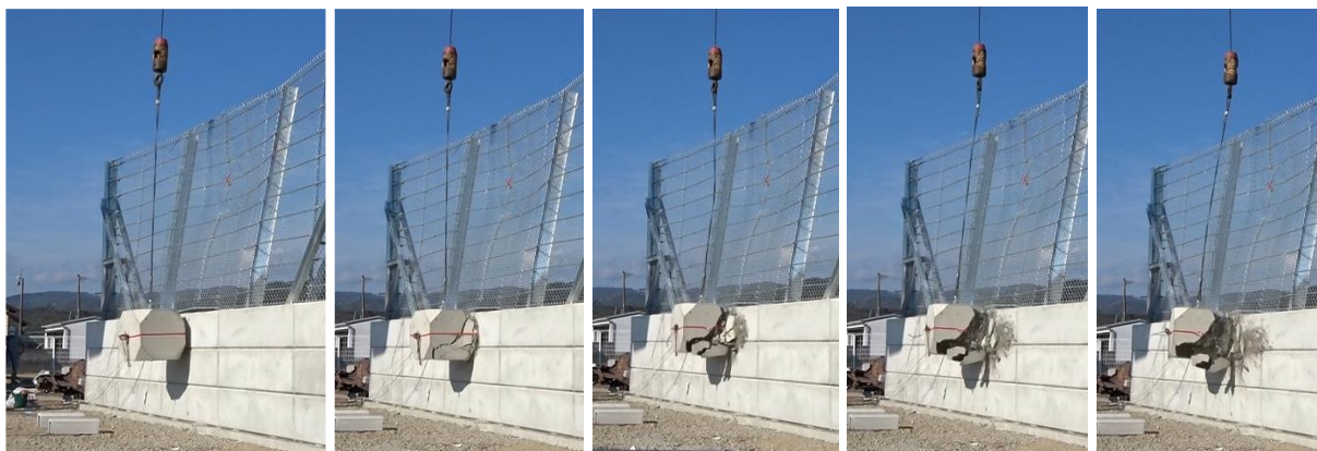
擁壁壁面へ重錘が衝突したときの挙動(ケース2の実験)
