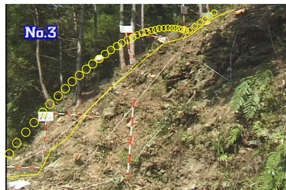
落石が切り株や突起に衝突したときの運動
