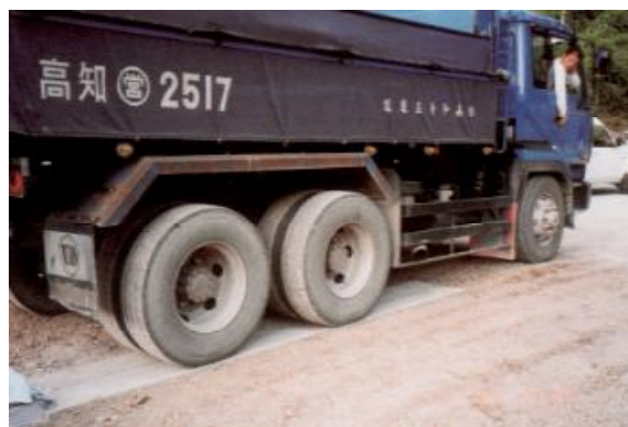
20トン車による載荷試験
