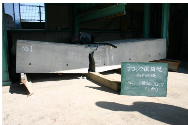
ブロック積み擁壁供試体の曲げ破壊
